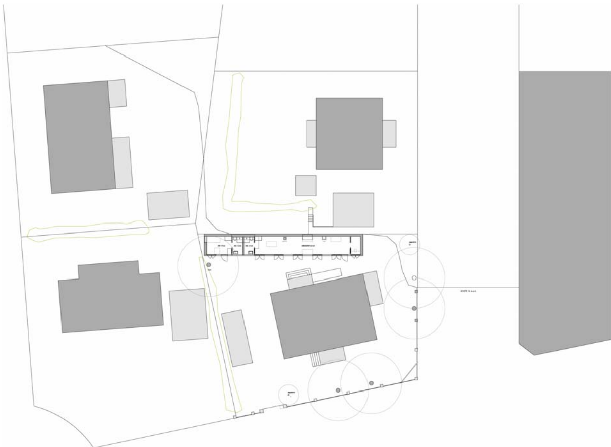
Situasjonsplan M 1:500 med terrengkvote ca 1 meter over gulvnivå (+14.0 m.o.h.) tegnet inn. Bygninger med to etasjer eller flere, har mørk farge, mens bygninger i en etasje har lysere farge (inkludert tiltaket).
